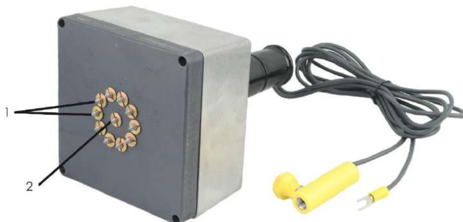
Рис. 5. Датчик для определения УЭС цилиндрических ниппелей
